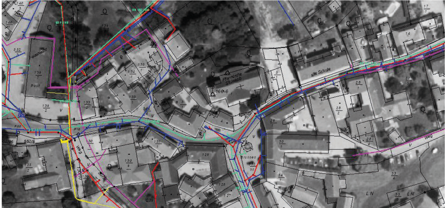
Luftbild mit Grenz- und Leitungskataster (Abwasser, Schmutzwasser – rot, Regenwasser - blau, Wasserversorgung - türkis, Fernwärme - rosa, LWL - gelb Quelle Orthofoto: Bundesamt für Eich- und Vermessungswesen
